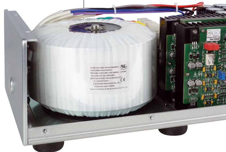
Bei Krell muss das so: Der Ringkernumspanner ist mit 1650 VA spezifiziert
